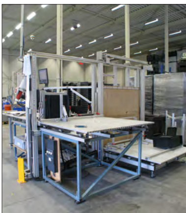
Spiegellasmachine voor het lassen van kunststof producten tot 1200 mm.
