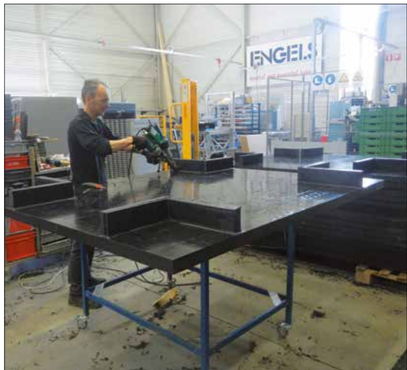
Aan elkaar gelaste pallets voor vervoer van brandstof tanks.
