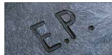
Markering d.m.v. brandstempel. Simpel en goedkoop.
