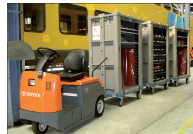
Versie met trekstangstelsel. In gebruik bij Nedtrain voor het verlenen van service aan persontreinen. Door de kunststof heen is de inhoud te controleren door RFID lezers.
