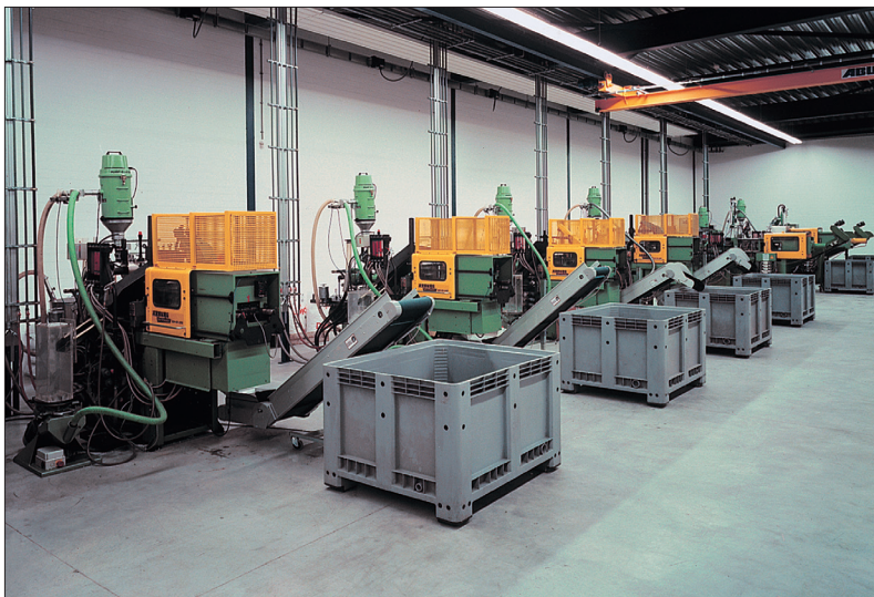
Palletboxen in gebruik in een spuitgietfabriek.
